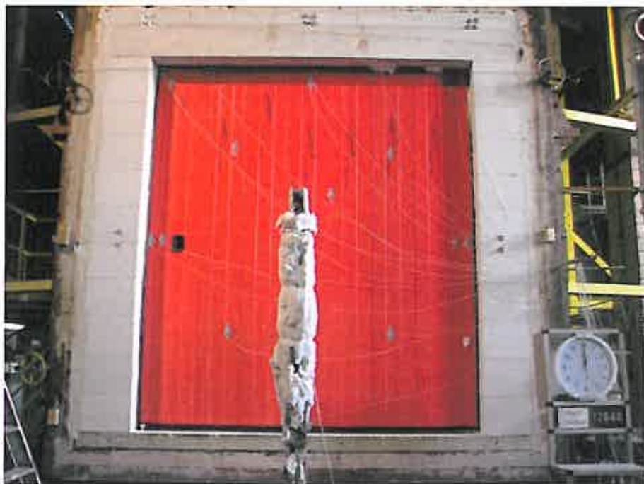
Face non exposée avant l'essai.
